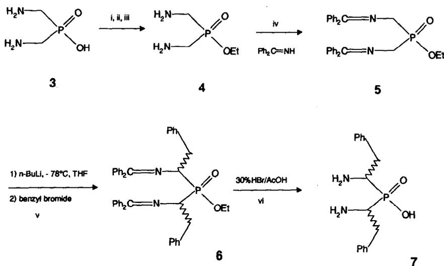
**Figure 2:** Synthesis of bis( $\alpha$ -amino-2-phenylethyl)phosphinic acid. i)  $\text{Boc}_2\text{O}$ , NaOH; ii) EtOH, DCC; iii) HCl, MeOH; iv)  $\text{CH}_2\text{Cl}_2$ , 24h, 53%; v) 24h at  $-78^\circ\text{C}$ , 95%; vi) **7**: R=H, 30% HBr/AcOH, 95%.- **8**: R=Et, 10% aq. HCl,
